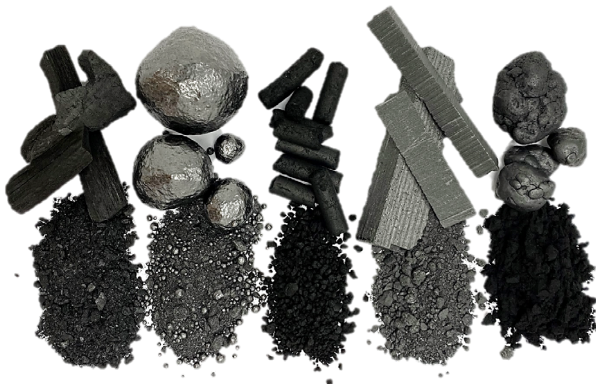
v.l.n.r. Holzkohle, Kohlenstoff-Agglomerate, Ruß-Koks-Pellets, Graphit-Blocks, Graphit-Mischung
